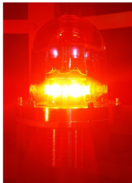
GF 300 im eingeschalteten Zustand Die Befestigung erfolgt über 4 M6 Schrauben im Abstand von 30x30mm
